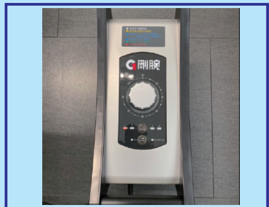
大型オゾン発生装置による 車内および施設内除菌
