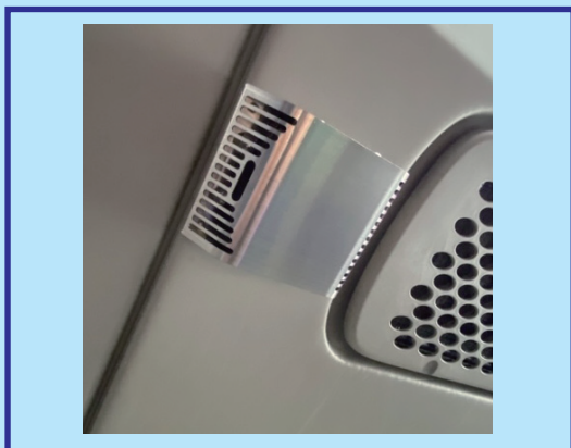
車内にはオゾン発生装置を設置 運行中は常に稼働します
